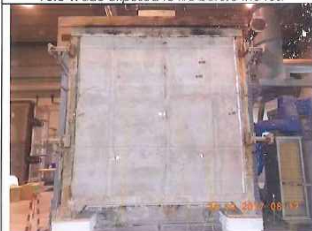
Foto 3: lato non esposto al fuoco dopo la prova Foto 3: side not exposed to fire after the test
