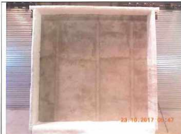
Foto 1: lato esposto al fuoco prima della prova Foto 1: side exposed to fire before the test
